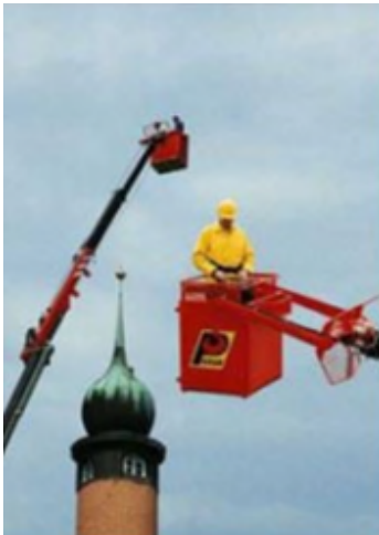
Arbeitsplattformen, die mit Ladekränen zusammengebaut sind
